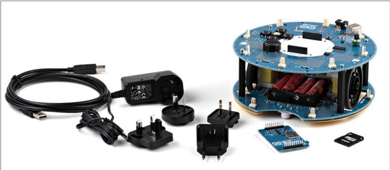
Arduino Robot è la prima scheda Arduino ufficiale su ruote. Il robot è dotato di due processori, uno su ciascuno dei suoi due assi. La scheda motore controlla i motori e la scheda di controllo legge i sensori e decide come operare. Ognuna delle schede è una scheda Arduino completa, programmabile utilizzando l'Arduino IDE. Entrambe le schede (sia quella motore che quella di controllo) sono schede a microcontrollore basate sull'ATmega32U4.
